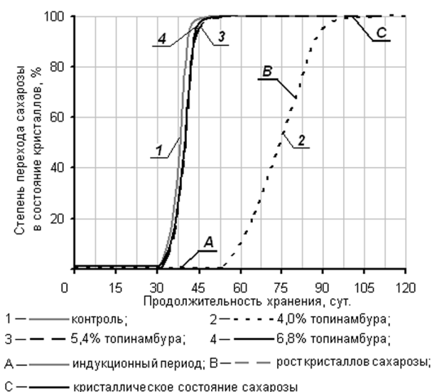
Рис. 2. Кинетические кривые процесса кристаллизации сахарозы в зефире с добавлением порошка топинамбура
