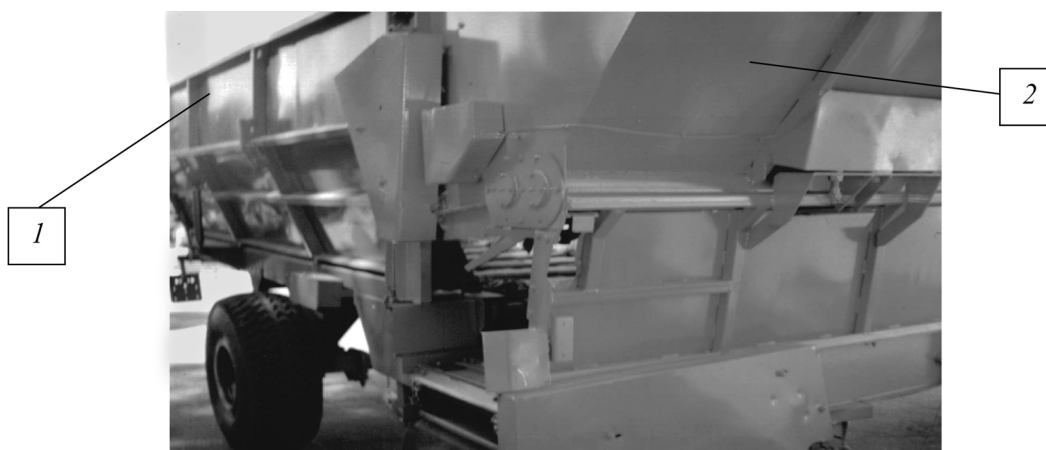
Рис. 3. Общий вид мобильного смесителя-раздатчика кормов: 1 – бункер для стебельчатых кормов; 2 – модуль для многокомпонентной высокоэнергетической добавки
