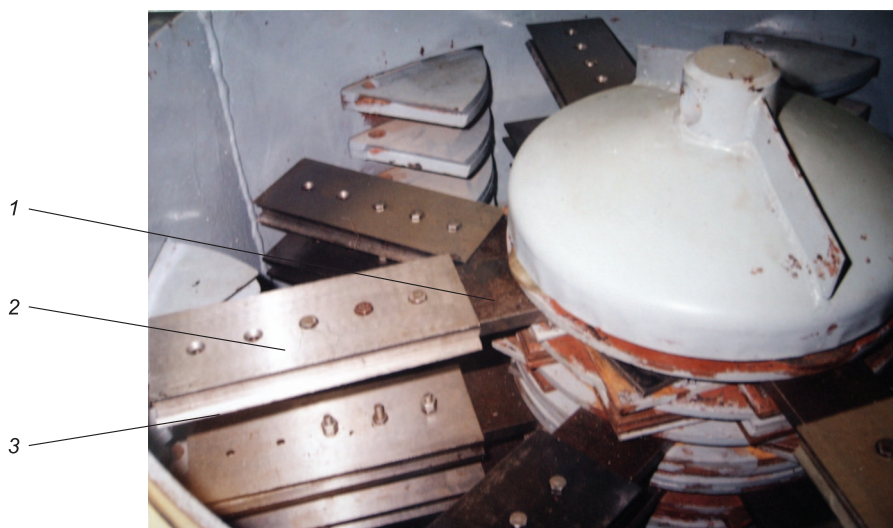
Рис. 5. Рабочий орган измельчителя кормов: 1 – державка; 2 – верхний нож; 3 – нижний нож
