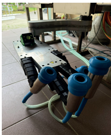
Рис. 5. Комплекс программно-аппаратный роботизированной системы доения КПРД
