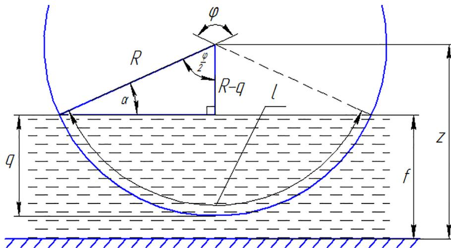
Рис. 3. Схема к определению длины дуги сегмента
