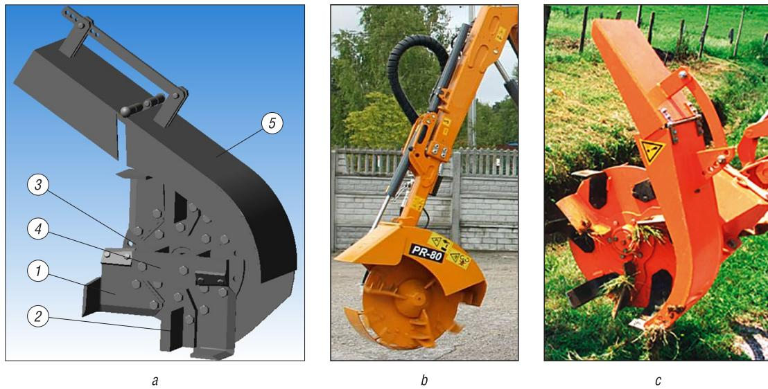
Рис. 1. Ротационные рабочие органы каналоочистителей: ротационный рабочий орган традиционной формы (*a*); рабочие органы каналоочистителей Rolmex R50/80, Польша (*b*); Noremat Ditch Cleaner, Франция (*c*)
