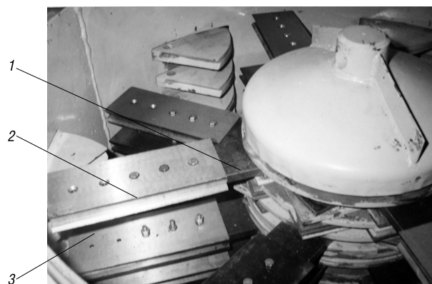
Рис. 5. Рабочий орган измельчителя кормов: 1 – державка; 2 – верхний нож; 3 – нижний нож
