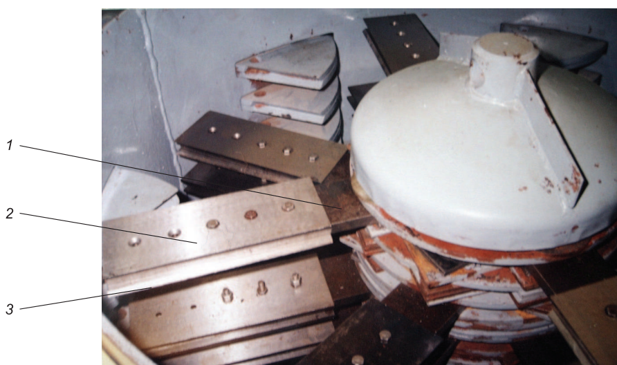
Рис. 5. Рабочий орган измельчителя кормов: 1 – державка; 2 – верхний нож; 3 – нижний нож
