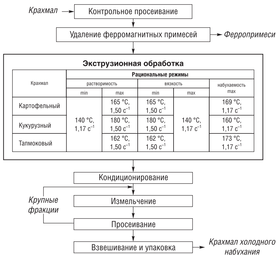
Рис. 7. Усовершенствованная технологическая схема получения набухающих крахмалов экструзией
